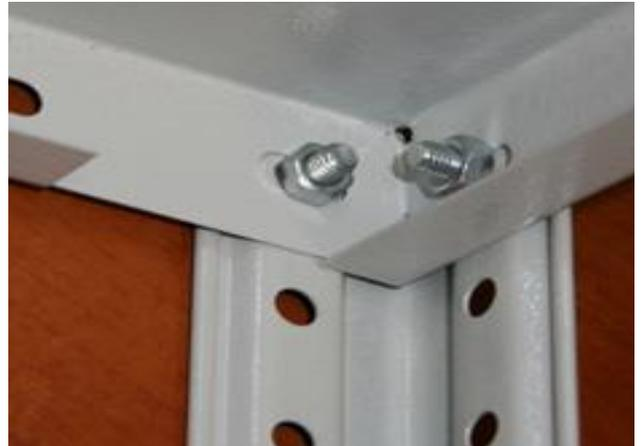
Промежуточные полки крепятся БЕЗ УГОЛКОВ, на 2 винта к каждой стойке.
