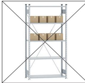
2. Полки следует нагружать распределенной нагрузкой, а не точечной.
